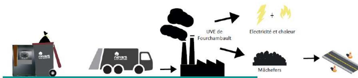
Les ordures ménagères collectées en régie par les agents de Nevers Agglomération sont acheminées à l'unité de valorisation énergétique de Fourchambault pour y être incinérées. Leur combustion permet la production de chaleur (chauffage de 3 770 équivalent logements) et d'électricité.
